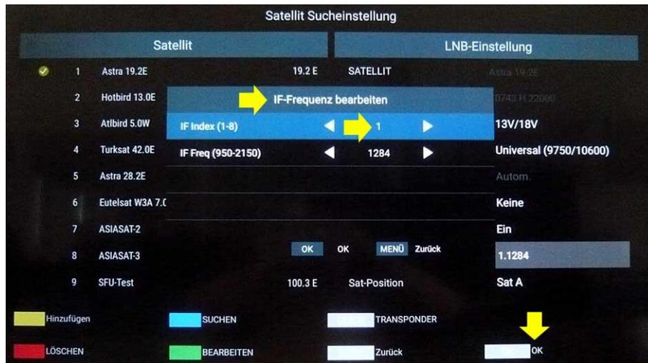
Unter dem Menüpunkt **IF-Frequenz** (SCR-Frequenz) werden 8 verschiedene IF-Frequenzen zur Auswahl angeboten.
