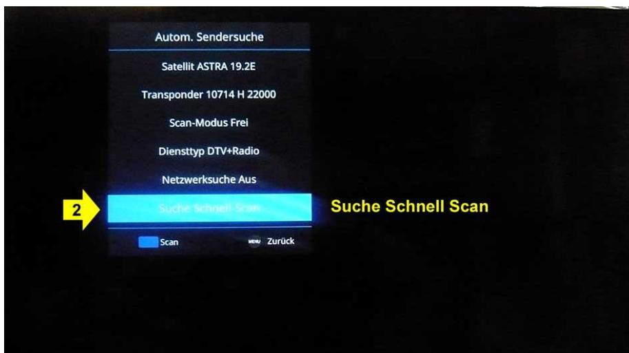
Drücken Sie anschließend die **blaue** Taste **[ B ]** der Fernbedienung um den Sendersuchlauf zu starten.
