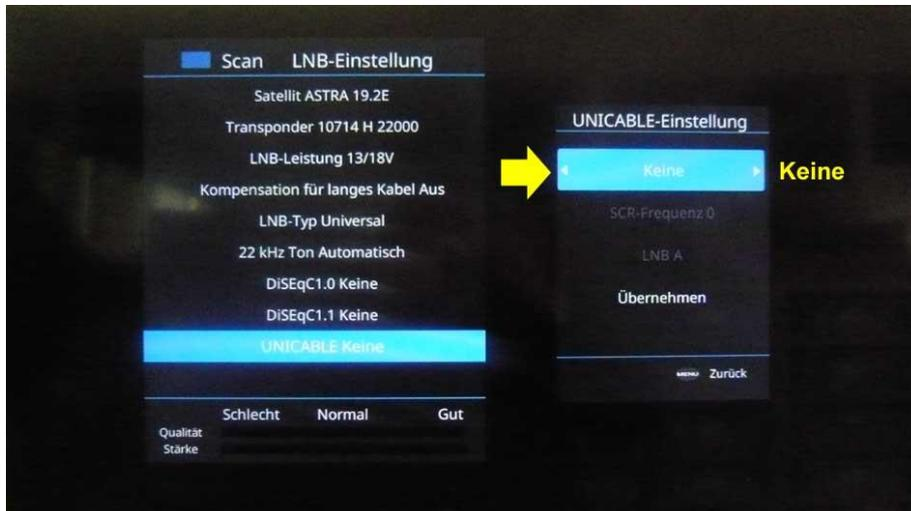
Am TV-Gerät stehen 9 verschiedene Punkte mit 8 verschiedenen SCR-Frequenzen am TV-Gerät zur Auswahl:
