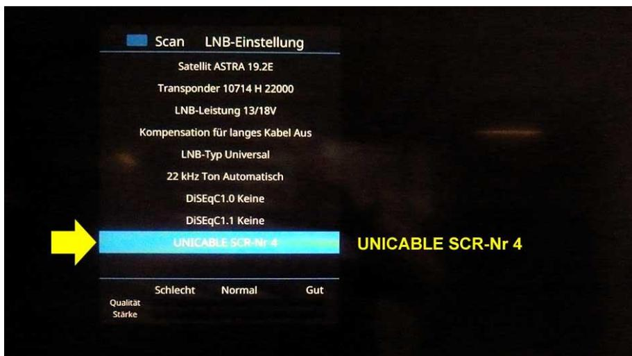
Drücken Sie nun die **blaue** Taste **[ B ]** der Fernbedienung um in das Menü für die Automatische Sendersuche zu wechseln.
