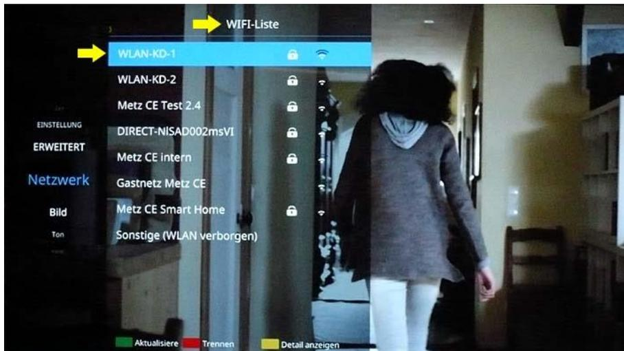
Das erste bzw. oberste WLAN-Netz (hier: „**WLAN-KD-1**“) ist dabei vor-ausgewählt und wird von einem blauen Feld hinterlegt.
