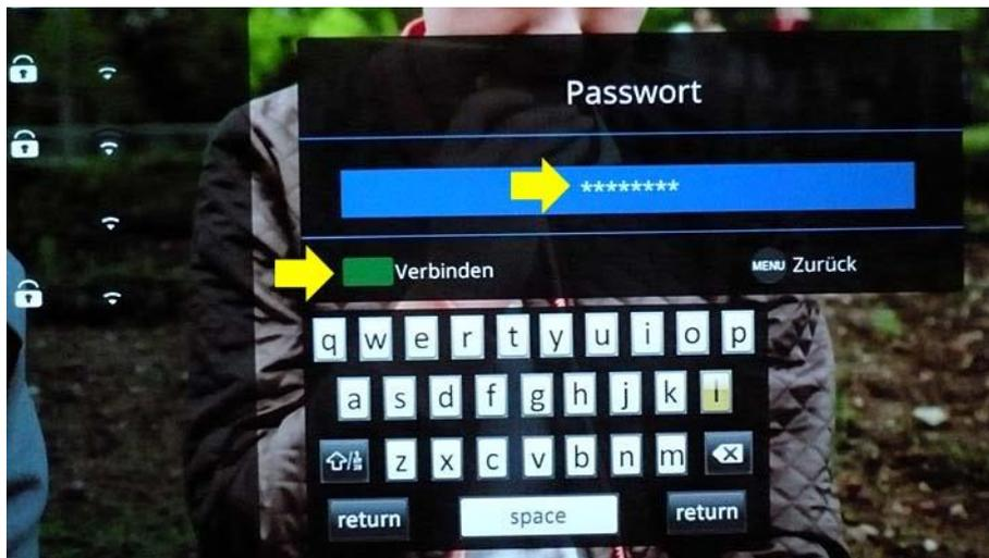
Die Eingabe des WLAN-Passwortes beenden Sie durch Drücken der Taste **GRÜN [ G ]** (Verbinden) der Fernbedienung.
