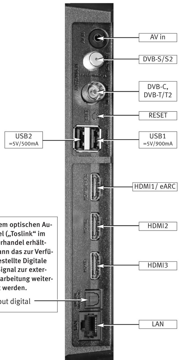
Mit einem optischen Audiokabel („Toslink“ im Zubehörhandel erhältlich), kann das zur Verfügung gestellte Digitale Audio Signal zur externen Verarbeitung weitergeleitet werden.
