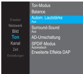
Stellen Sie die Lautstärke entsprechend dem Eingangspegel des externen AV-Gerätes ein. Wählen Sie "Ein", das Fernsehgerät passt automatisch die Lautstärke an.
